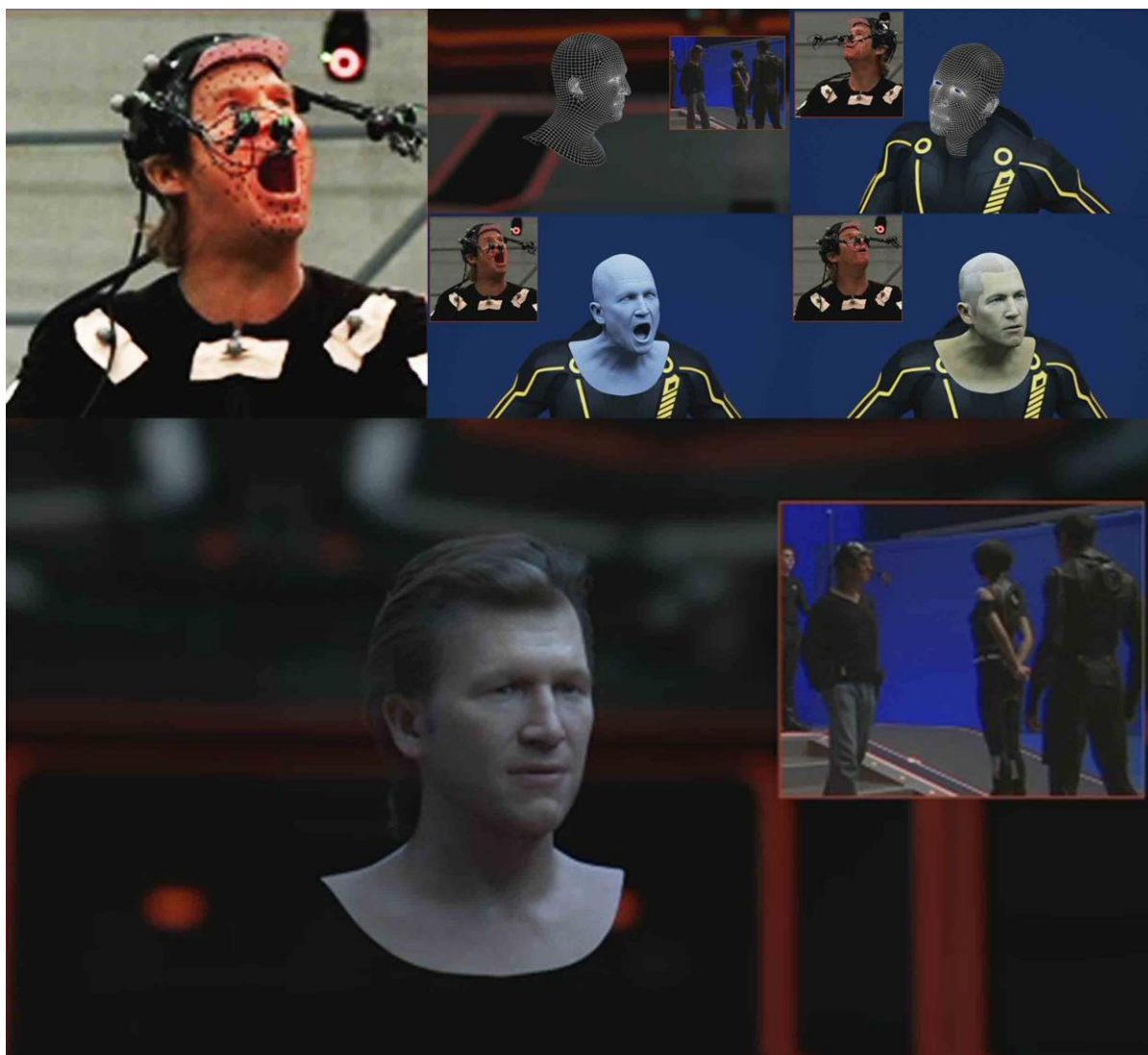
Herec Jeff Bridges má na obličejí markery a snímače Facial Motion capture pro modelování výrazů 3D tváře pro film TRON: Legacy z roku 2010 ve studiu společnosti Digital Domain.
