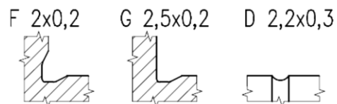
Obr. 84: Specifikace zápichů na výkrese
