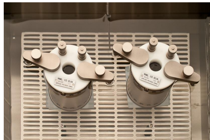
Etalony odporů 1Ω v olejovém termostatu (převzato z:www.cmi.cz)
