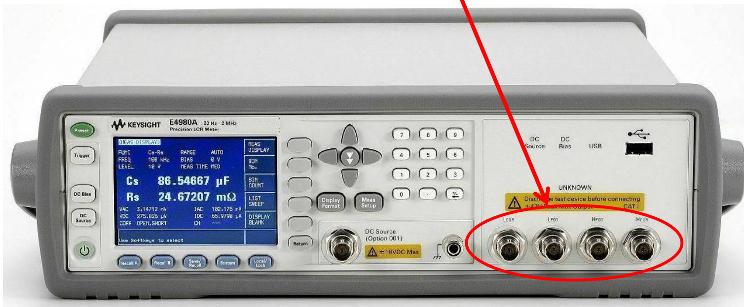
RLC měřič E4980A, Keysight (převzato z: https://www.keysight.com/ )
