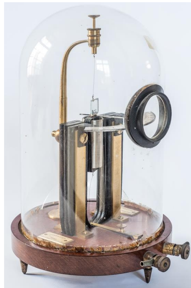
Původní konstrukce galvanometru systému Deprez- d'Arsonval
