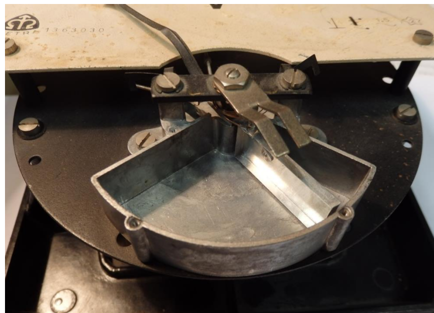
Vzduchové tlumení (otevřená komora)
