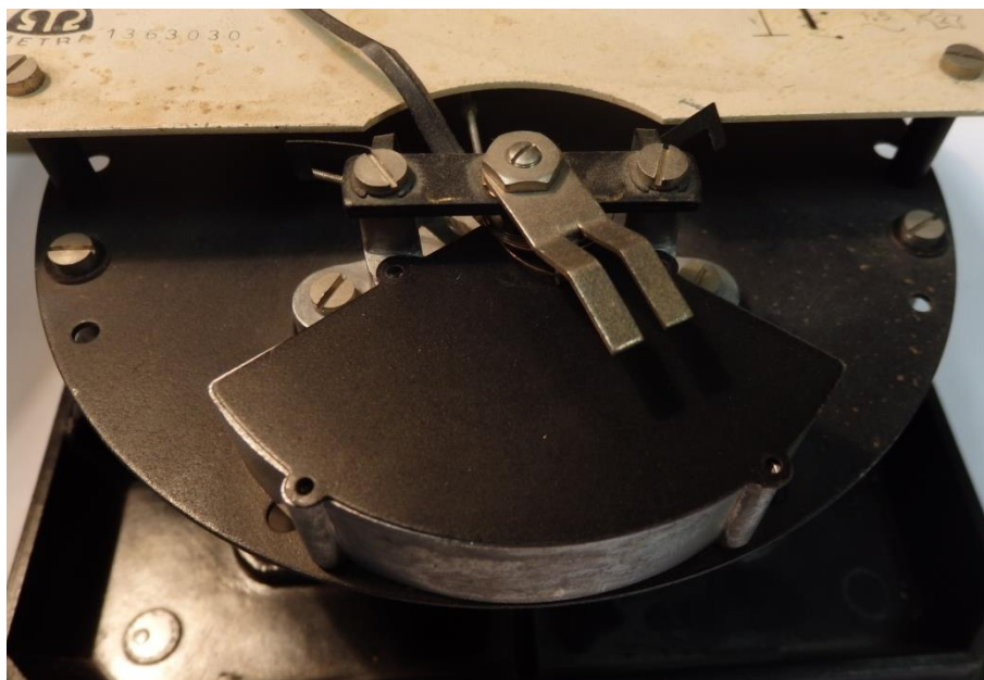
Vzduchové tlumení (uzavřená komora)
