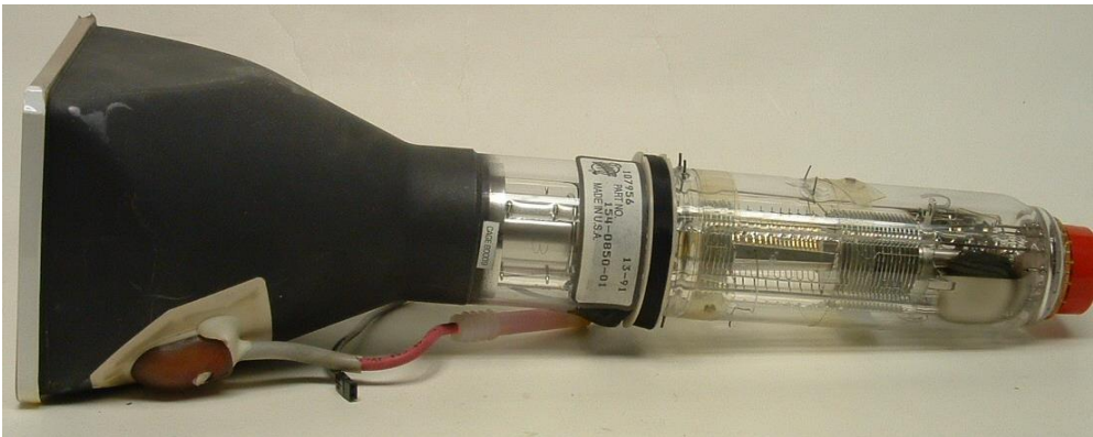
Obrazovka Tektronix 154-0850-01, osciloskop Tek2445B (převzato z: https://www.crtsite.com/oscilloscope-crt.html )
