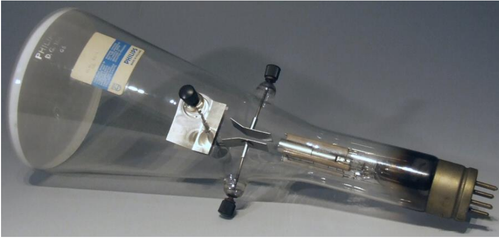
Oscilopická obrazovka DG16-1 Philips, 1936 (převzato z: https://www.crtsite.com/oscilloscope-crt.html )
