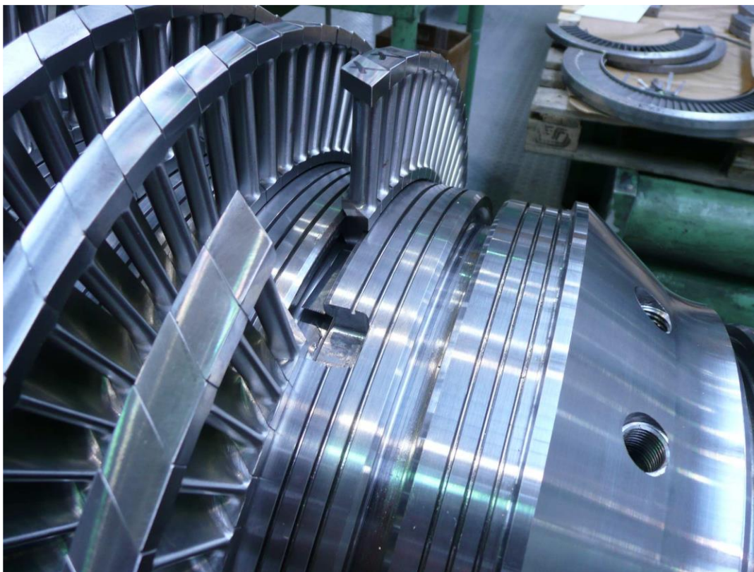
Rotor při montáži lopatek
